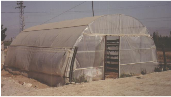
Őekil 28. Ege niversitesi Gneř Enerjisi Enstits'nde yapılan bir arařtırmada geliřtirilen sera tipi (tnel) kurutucu, kurutma raflarında sultana tip ekirdeksiz zm kurutulurken [9].
