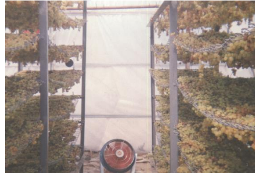
Őekil 28. Ege niversitesi Gneř Enerjisi Enstits'nde yapılan bir arařtırmada geliřtirilen sera tipi (tnel) kurutucu, kurutma raflarında sultana tip ekirdeksiz zm kurutulurken [9].
