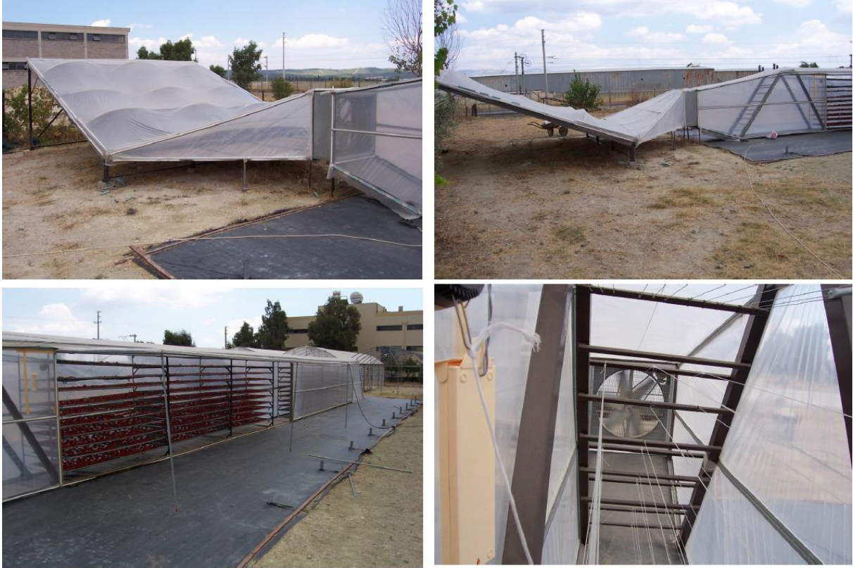
Şekil 30. Prof.Dr.Gazanfer HARZADIN firması tarafından geliştirilen tünel tip, havalı toplayıcı, aktif güneş enerjili kurutucu.
