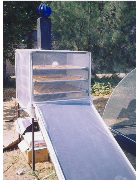
Şekil 6. Ege Üniversitesi'nde Prof.Dr.Gazanfer HARZADIN'ın firmasının katkılarıyla, kayısı kurutulmasında denenen hibrit tip, pasif bir kurutucu.
