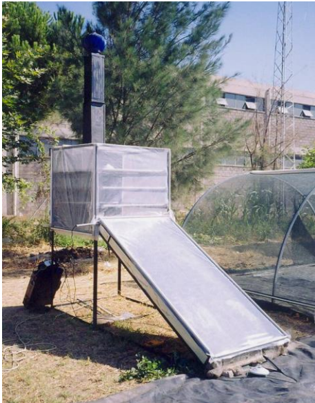
Şekil 6. Ege Üniversitesi'nde Prof.Dr.Gazanfer HARZADIN'ın firmasının katkılarıyla, kayısı kurutulmasında denenen hibrit tip, pasif bir kurutucu.
